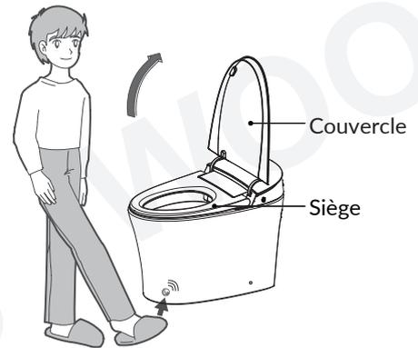
2. Lorsque le couvercle est ouvert et le siège fermé, touchez la zone de détection avec le pied pour ouvrir le siège.
