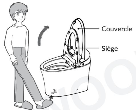
3. Lorsque le siège et le couvercle sont ouverts, touchez la zone de détection avec le pied pour fermer le siège et le couvercle et activer un demi-balayage.
