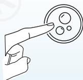
Avant de démarrer l'écran à mousse pour la première fois, l'agent moussant doit être pompé dans l'écran à mousse à l'aide de la commande "pomper le liquide".
